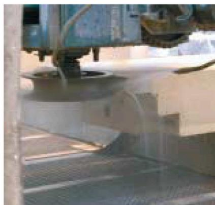
Abb. 10: Diamantbohrfräser, Handlaufbearbeitung
